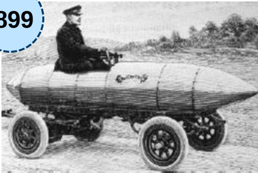
Coche Belga con baterías de Pb ácido con velocidades de 30 m/s.
